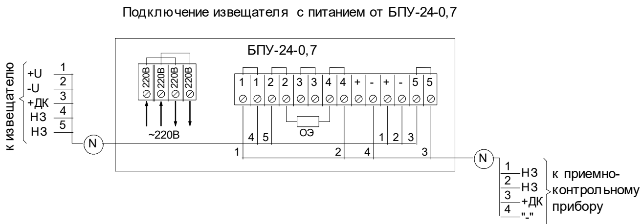
Рисунок 2.12 – Схема подключения извещателя к блоку питания «БПУ-24-0,7»
